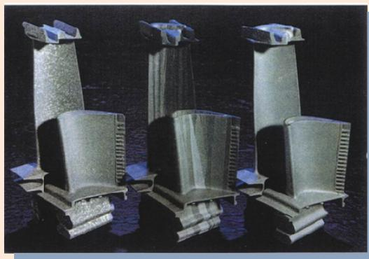
图 14 第一、二、三代航空发动机高温合金叶片
