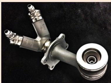
图 21 航空发动机高温合金喷嘴
