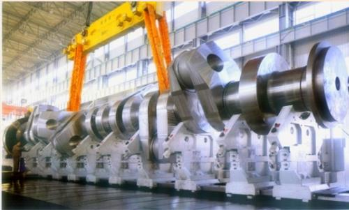
图8 船用大型曲轴用锻件
