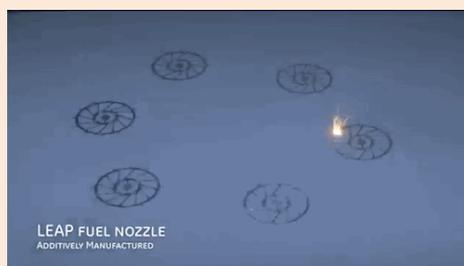
图 22 增材制造打印喷嘴（DMLM 技术）
