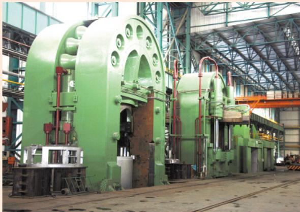
图 25 3.6 万吨黑色金属垂直挤压机
