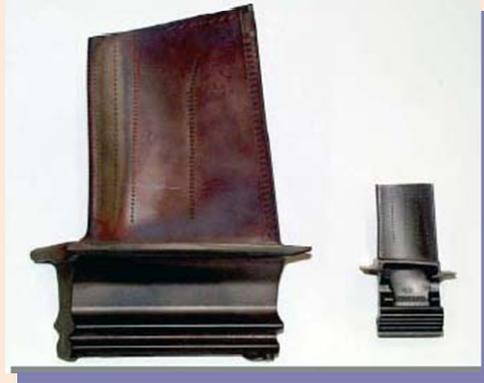
图 5 航空发动机及重型燃机高温合金定向凝固叶片
