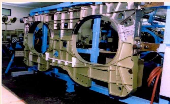
图 23 激光快速成形制造的战机后机身隔框
