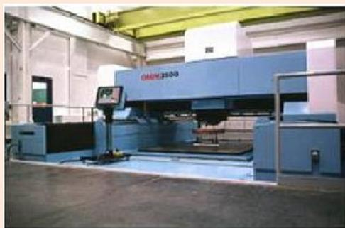
图 9 大型数控超精密机床 OAGM
