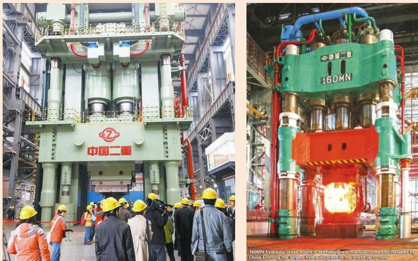
图 1 中国二重集团公司的 8 万吨模锻设备及 16000 吨水压机
