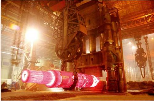
图7 特大型核电站转子锻件
