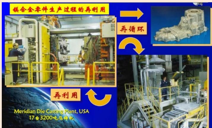
图 30 美国 Meridian 压铸工厂的镁合金再利用流程
